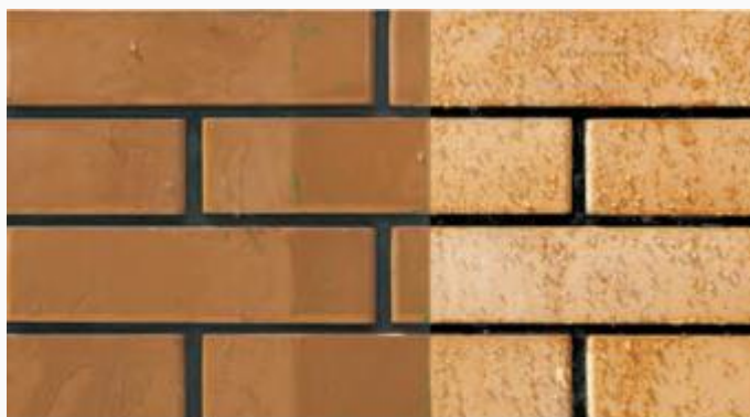
Не обработанный кирпич (слева) намокает, а обработанный (справа) отталкивает воду
