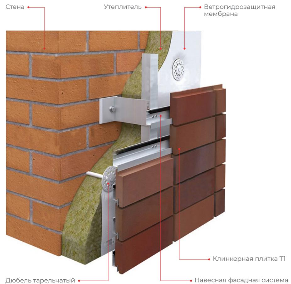
Другим ключевым преимуществом такой системы является отсутствие мокрых процессов по подготовке основания и приклеиванию плитки, как это происходит при монтаже многослойных фасадных теплоизоляционных систем.
